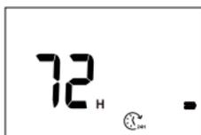
Drücken Sie die "+" oder "-"-Taste, um die Verzögerungszeit für die Bewässerung einzustellen (24 Stunden, 48 Stunden oder 72 Stunden)
