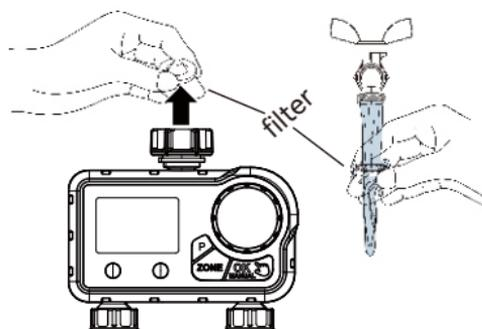
3. Encienda el modo de riego manual del temporizador para abrir la válvula y verifique si la tubería de agua del temporizador está bloqueada. Si está bloqueado, límpielo suavemente con un cepillo de limpieza pequeño.
