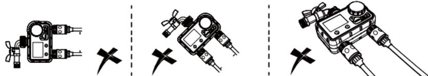
**CONSEJO:** Si la conexión entre el temporizador y el grifo o la manguera no está apretada o tiene fugas, envuelva más cinta de teflón (cinta selladora de roscas) para que queden apretadas.
